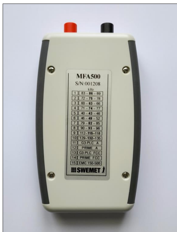
Vue arrière avec le descriptif des 15 filtres passe bandes
